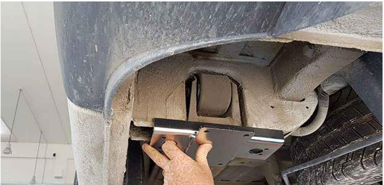
Bringen Sie den Adapter in der auf dem Foto gezeigten Position hinter dem Träger der Armbrustaufhängung an.
