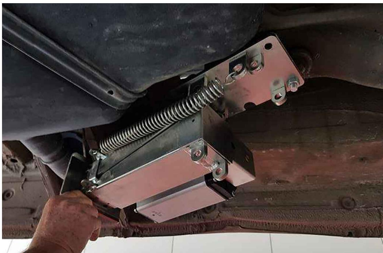
Die Motorbuchse zeigt zur Außenseite des Fahrzeugs und die Drehung nach hinten
