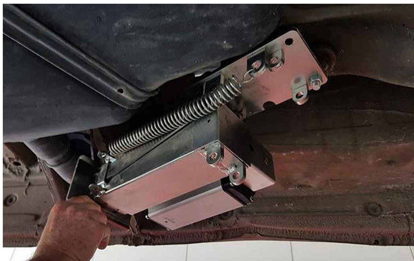
Gato motor orientado hacia el exterior del vehículo y rotación hacia la parte trasera
