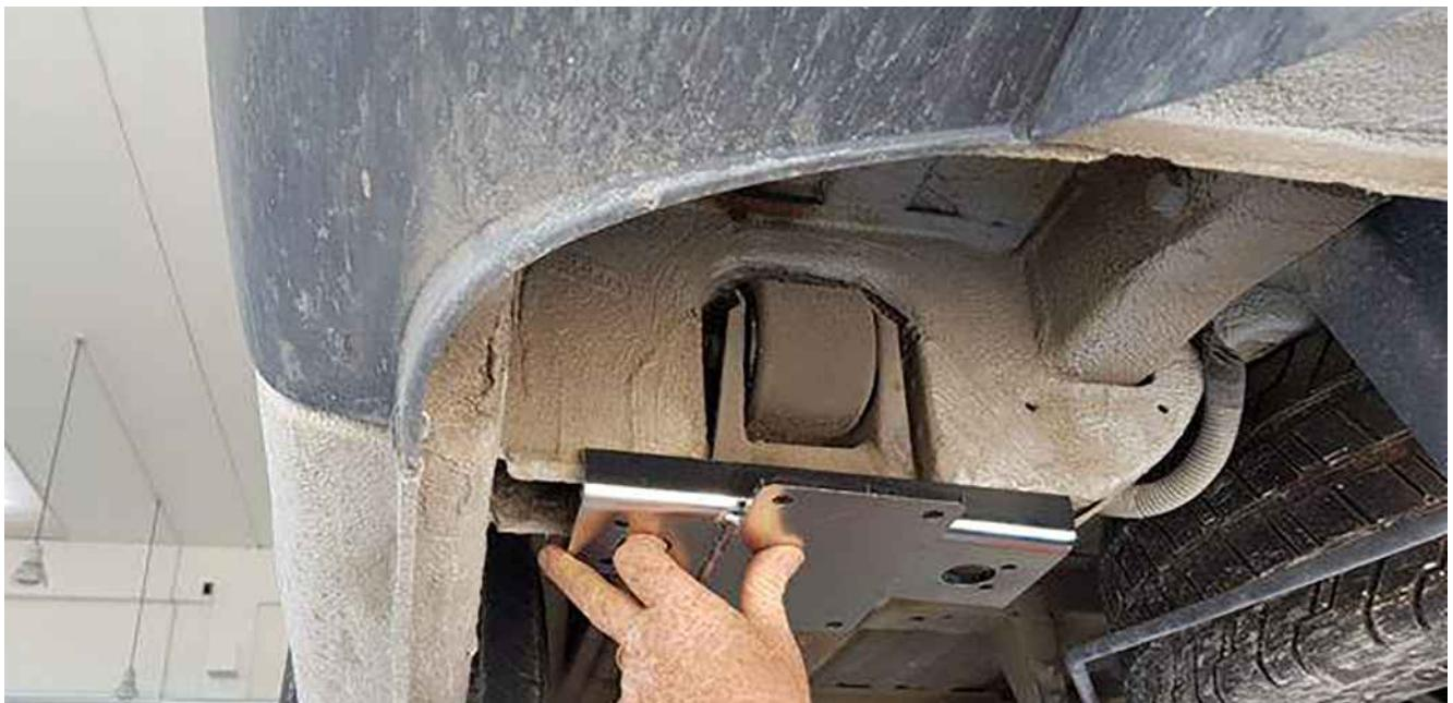
Colocar el adaptador en la posición indicada en la foto, detrás del soporte de la suspensión de la ballesta.
