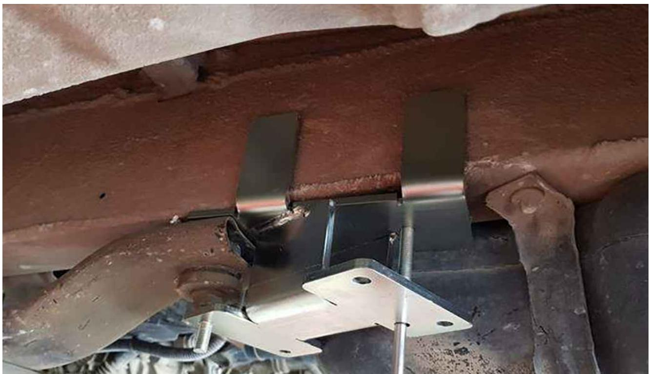
Fijar el adaptador con un tornillo M10.
