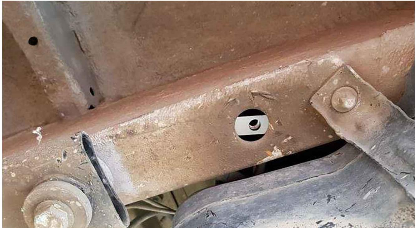
Inserire la piastra di tenuta nel foro del telaio, inserire l'adattatore e spingere verso la parte anteriore.
