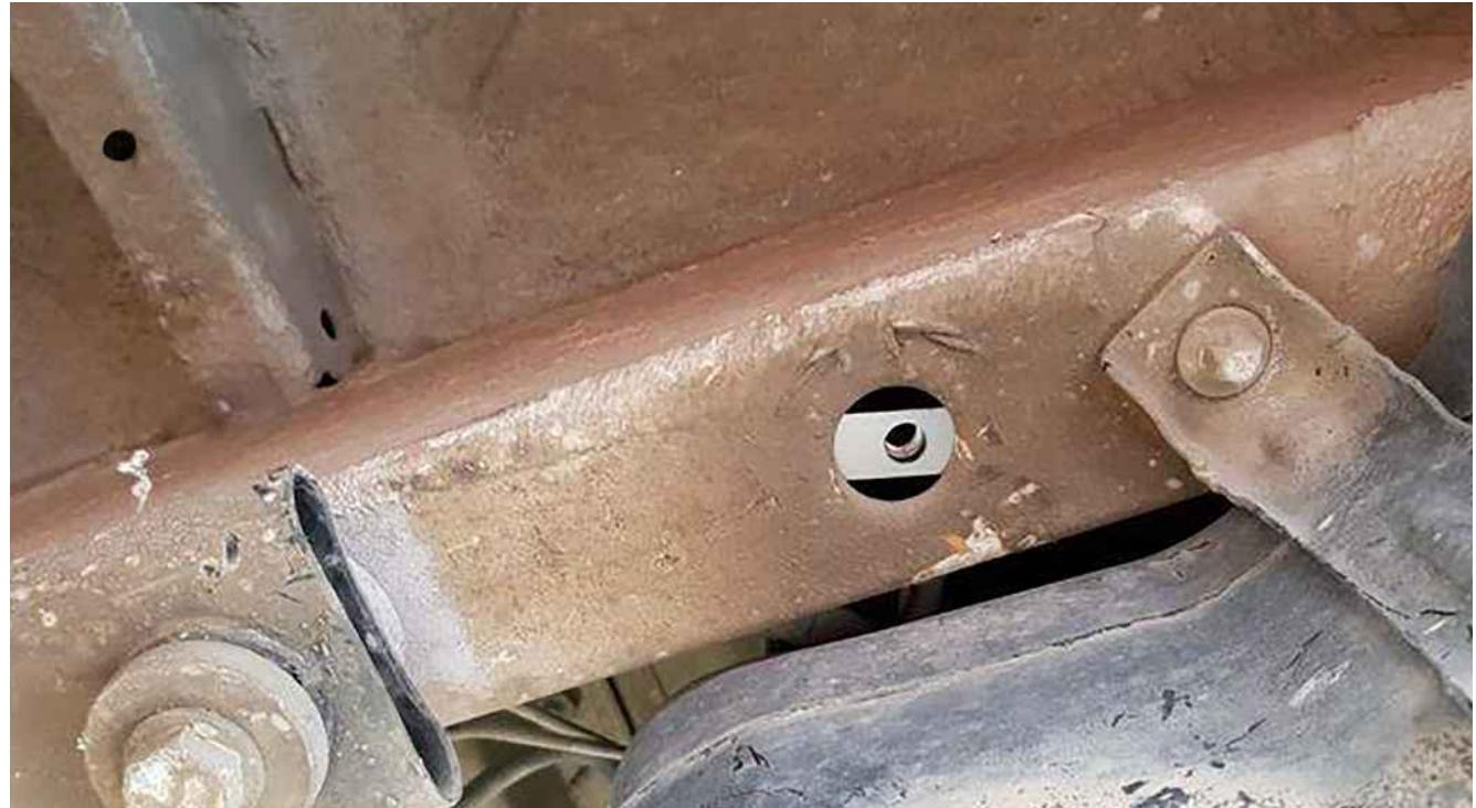
Sätt in tätningsplattan i hålet på ramen, sätt på adaptern och tryck den framåt.
