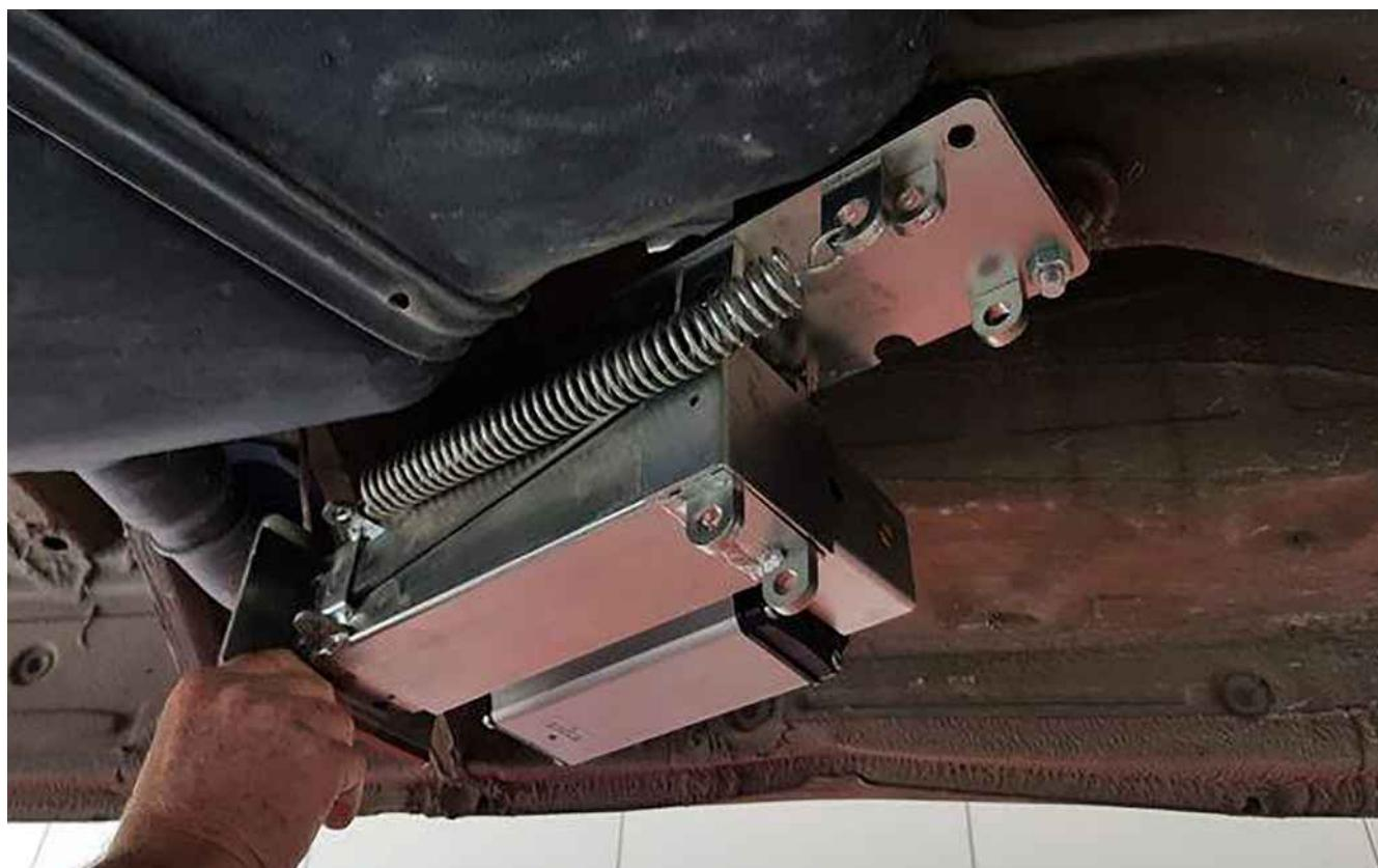
Martinetto motore rivolto verso l'esterno del veicolo e rotazione verso la parte posteriore
