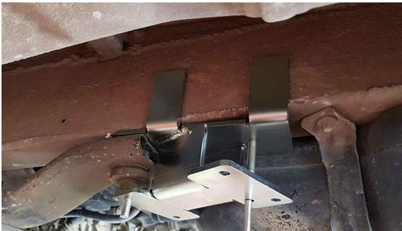
Befestigen Sie den Adapter mit einer M10 Schraube.
