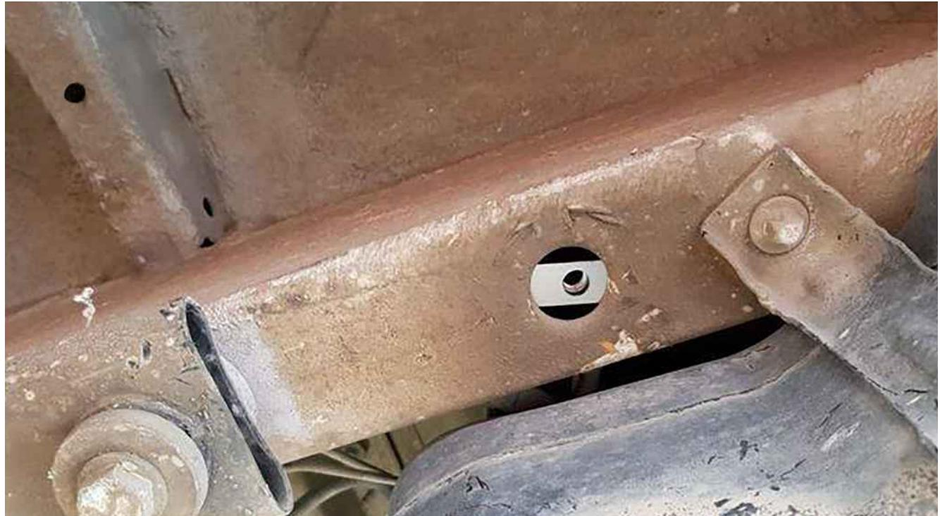
Die Dichtungsplatte in das Loch am Rahmen einsetzen, den Adapter aufsetzen und nach vorne drücken.
