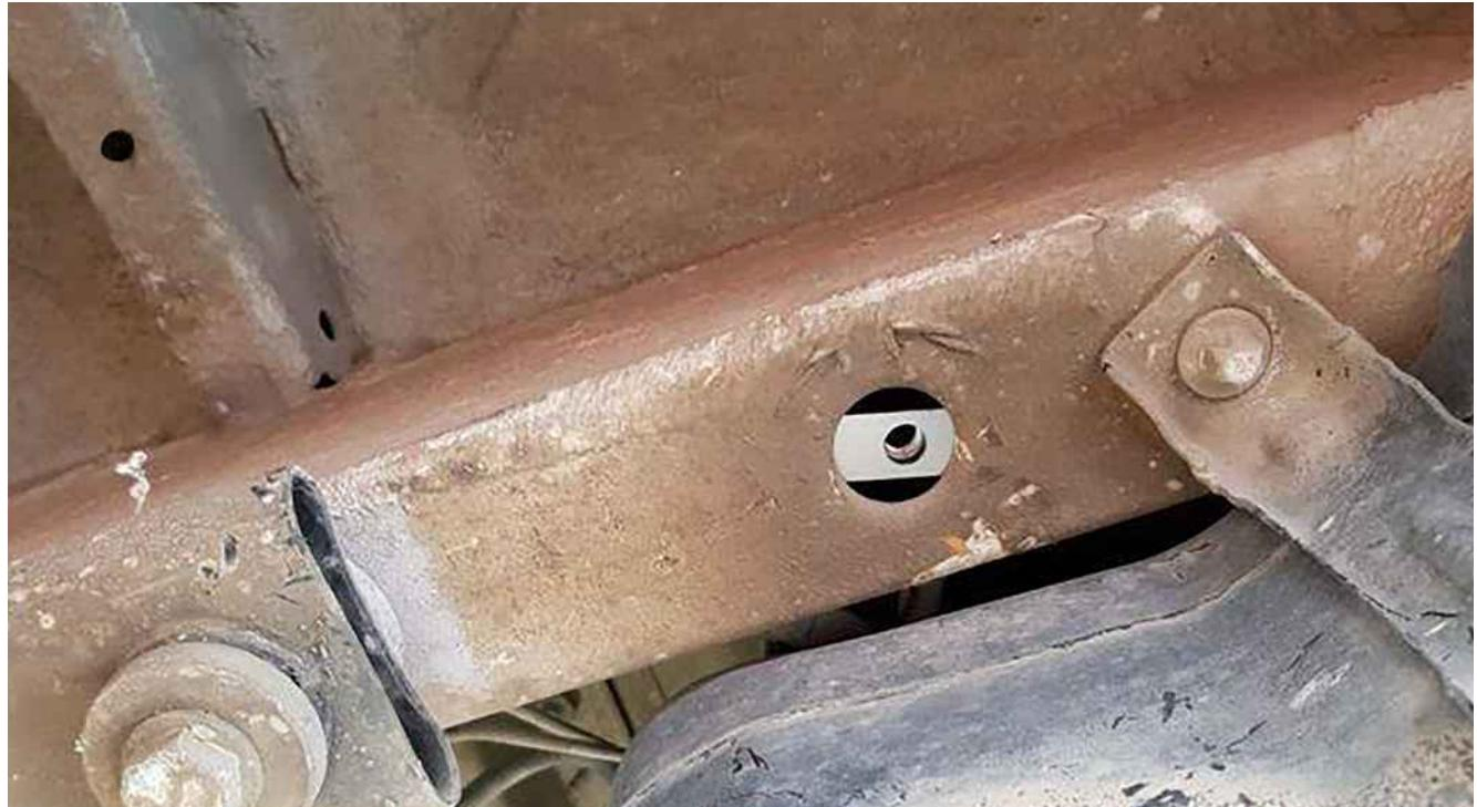
Insérez la plaque d'étanchéité dans le trou du châssis, mettez l'adaptateur et poussez vers l'avant.
