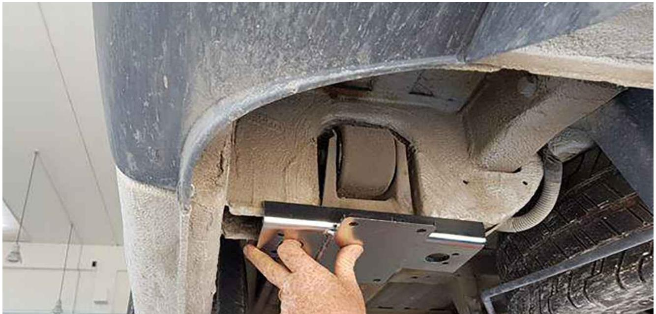
Sæt adapteren i den position, der er vist på billedet, bag støtte for krydsophænget.
