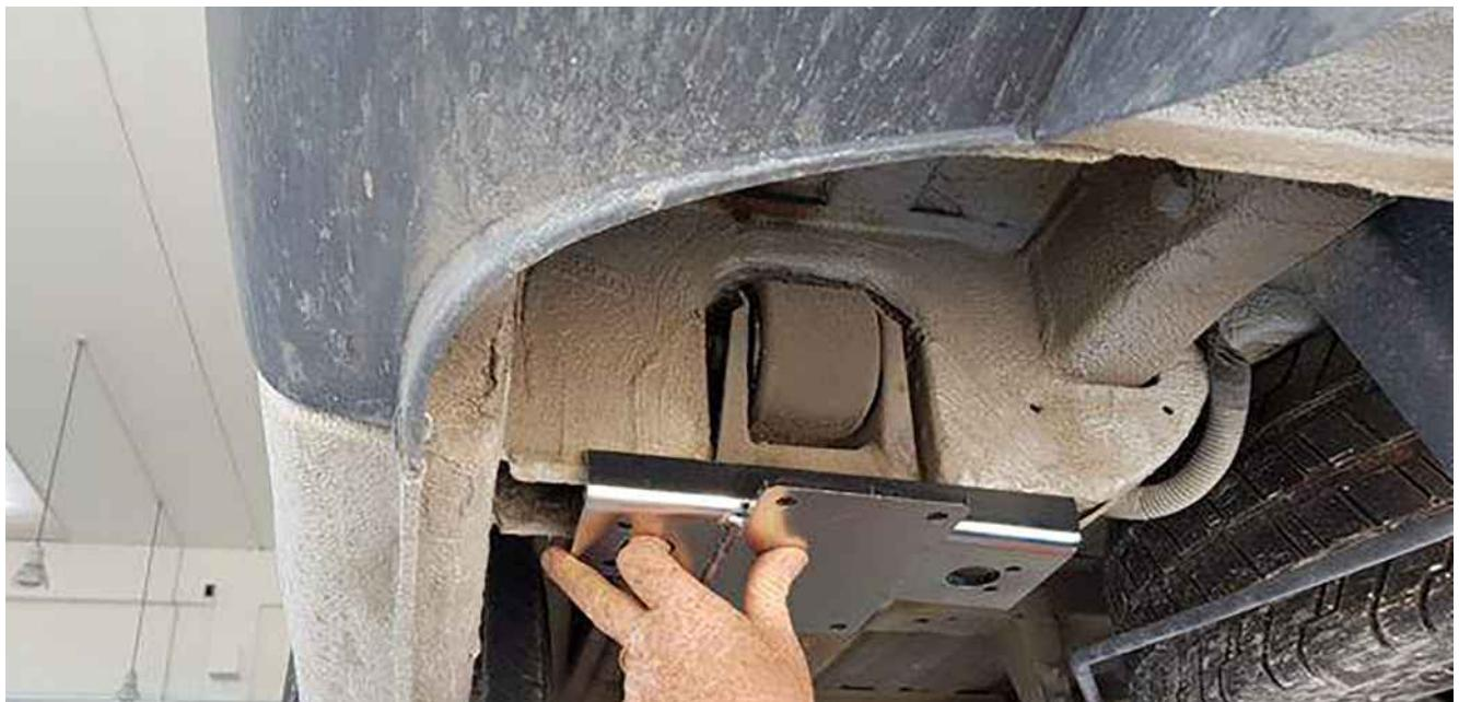
Placez l'adaptateur dans la position indiquée sur la photo, derrière le support de la suspension de l'arbalète.
