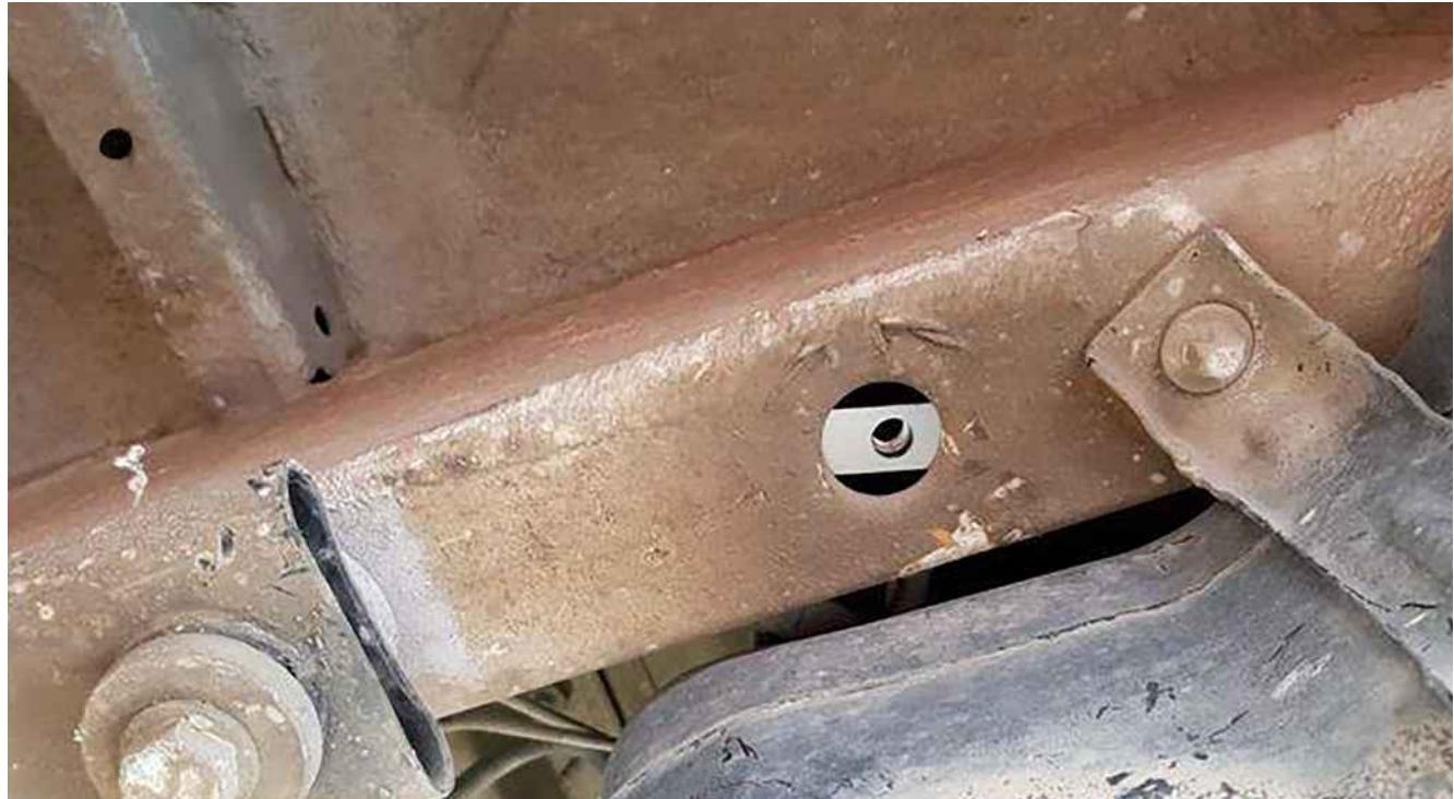
Plaats de afdichtplaat in het gat op het frame, plaats de adapter en duw naar voren.
